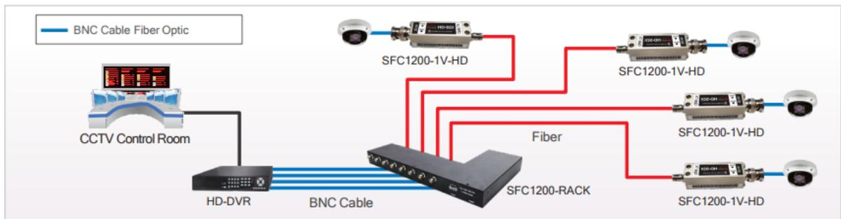
SFC1200-RACK 제품에 SFC1200-1V-HD(RX)를 최대 8대를 장착하여 19" Rack Chassis(1U Size)로 설치하고, SFC1200-1V-HD(TX)를 카메라가 있는 장소에 연결하여 시스템을 운영 할 수 있는 구성도입니다.
