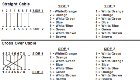
그림 A-1: 스트레이트 연결과 크로스 연결 케이블
