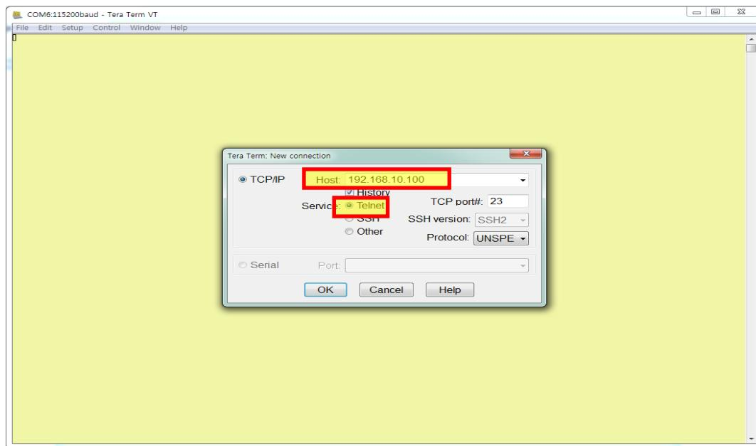
위의 Host 부분에 Telnet 으로 통신할 장비의 ip 를 입력하고 Service 에 Telnet 을 선택하고, OK 버튼누르면 다음과 같이 연결이 됨을 확인 할 수 있습니다.
