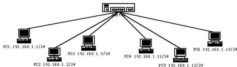
사용자 PC1 ~ PC6 은 포트 1 ~ 6 을 통해 스위치를 연결합니다. 이 PC 의 IP 주소는 네트워크 섹션 192.168.1.0/24 에 속합니다. PC1 ~ PC3 그룹과 PC4 ~ PC6 그룹은 서로 다른 계층 2 브로드 캐스트 도메인에 위치하지만 PC1 ~ PC6 은 서로 ping 을 수행하고 IP 주소 192.168.1.100 을 통해 스위치를 관리 할 수 있습니다. 이렇게 하려면 포트 1 ~ 3 을 VLAN1 로, 포트 4 ~ 6 을 VLAN2 로 구성해야 합니다. 그런
