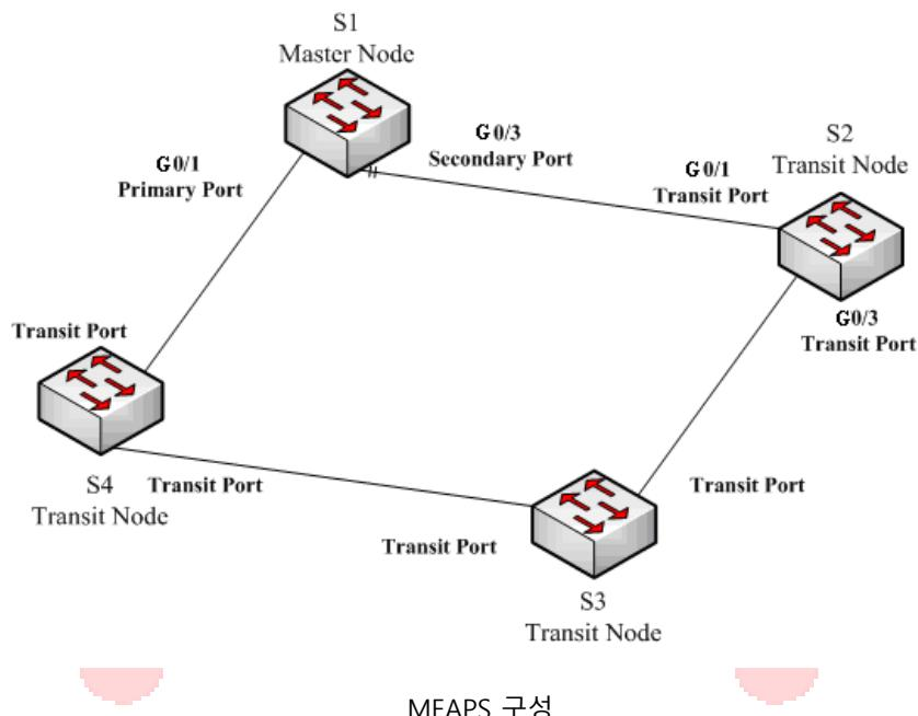
그림 2.1에서와 같이 마스터 노드 S1과 중계 노드 S2는 다음과 같이 구성됩니다. 다른 노드의 구성은 S2의 구성과 동일합니다.
