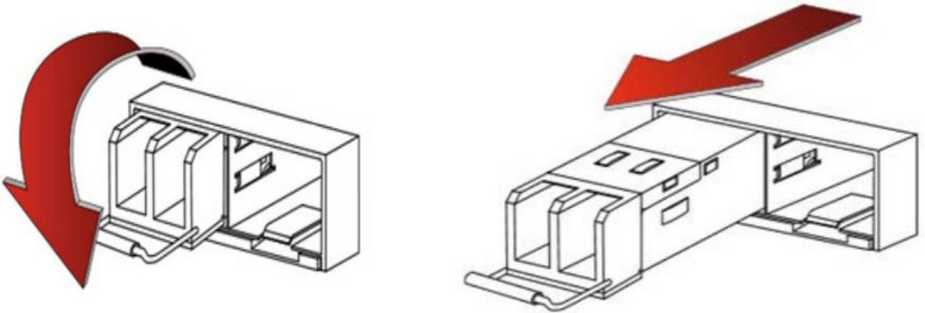
Notice : 난폭하게 다루거나 SFP 모듈의 푸시 볼트를 잡고 모듈을 고집어 내지 마십시오. 당길 때 Security Certified Industrial Managed 10G Ethernet Switch 및 SFP 모듈 슬롯을 손상시킬 수 있습니다.
