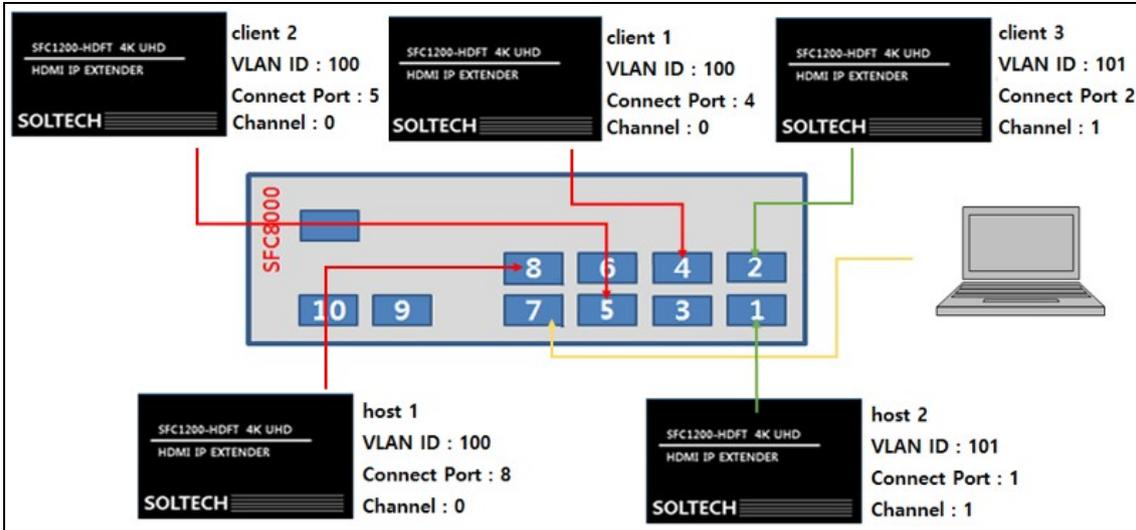
VLAN ID 를 설정하면 가 같은 장비끼리만 통신합니다. host1 에서 설정한 VLAN 과 client3 에서 설정한 VLAN 의 ID 값이 다르기 때문에, 서로간의 통신이 불가능합니다. 이를 이용하여 장비를 그룹화 하여 이용할 수 있습니다.
