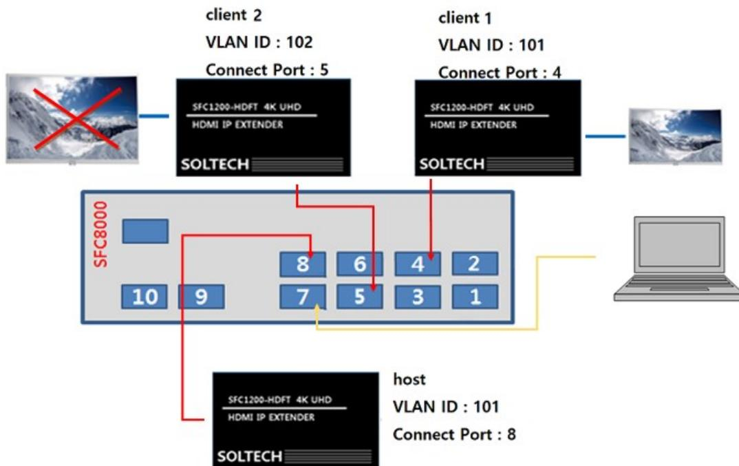
본 예시는 솔텍 장비를 이용하여 만든 구성 예시입니다. SFC 1200-HDFT 장비들과 산업용 스위치 SFC 8000 을 이용하였으며, 꼭 예시 스위치가 아니더라도 스위치가 VLAN 을 지원하거나 IGMP 를 지원하고, 점보 프레임을 8K 이상 지원하는 다른 스위치를 이용하셔도 문제 없습니다.
