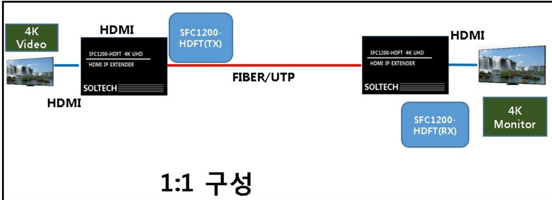
**1 단계:** 영상 소스 근처에 SFC1200-HDFT(TX) 장비를 고정시킨 후, 수신단의 모니터 근처에 SFC1200-HDFT(RX) 장비를 고정시키며 주변 물체 사이에 충분한 통풍공간을 유지 하십시오..
