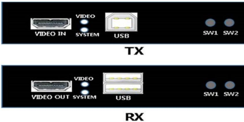
Tx 장비엔 USB B Type 1 개, Rx 장비엔 USB A Type 2 개가 있으며 공통적으로 1 개의 HDMI 포트 그리고 2 개의 버튼식 스위치가 있습니다.
