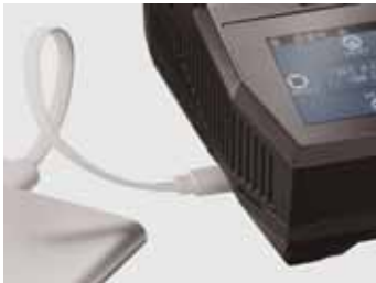
▶ 마이크로 5핀 충전 시스템 (휴대용 보조배터리 가능)
