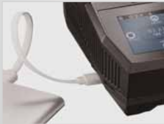
마이크로 5핀 충전 시스템 (휴대용 보조배터리 가능)
